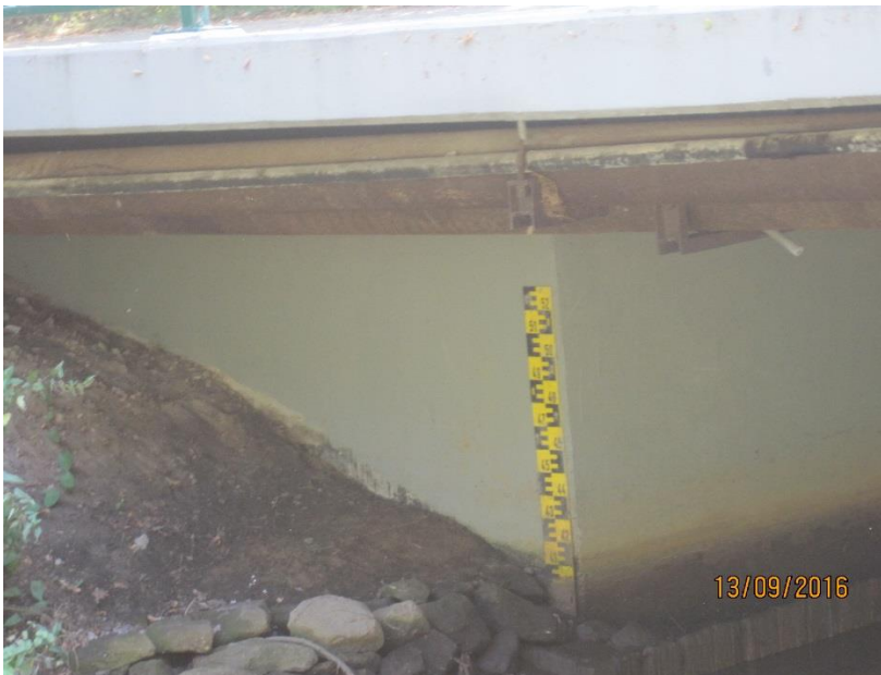
Abbildung 3: Aufbau des Pegels „Nordenhammer Straße (Delme)“
