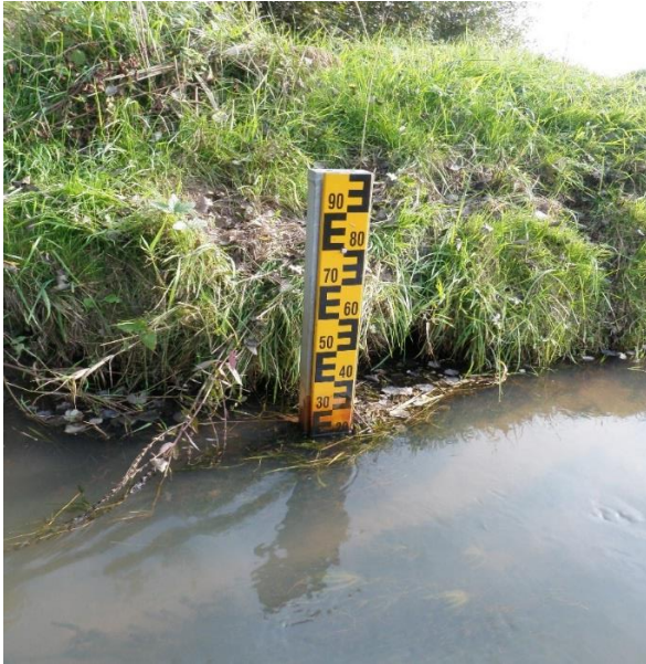
Abbildung 2: Aufbau des Pegels „DB1 (Dünsener Bach)“ mit Pegellatte und abgesetzter Pegelmesseinrichtung
